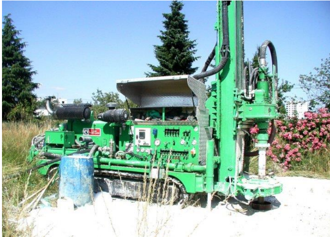
Foreuse sur chenilles (@BRGM)
