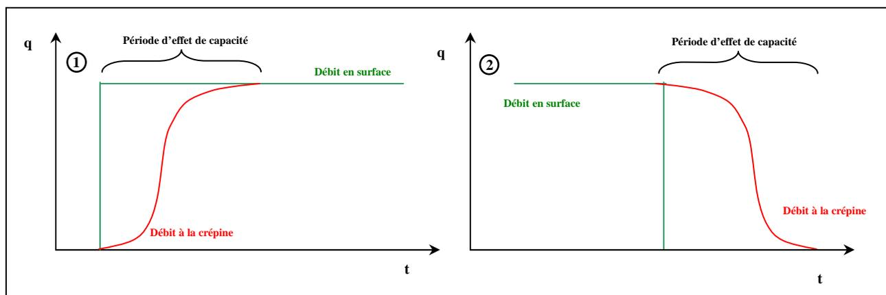
**Figure A3-1: Représentation de l'effet de capacité**
