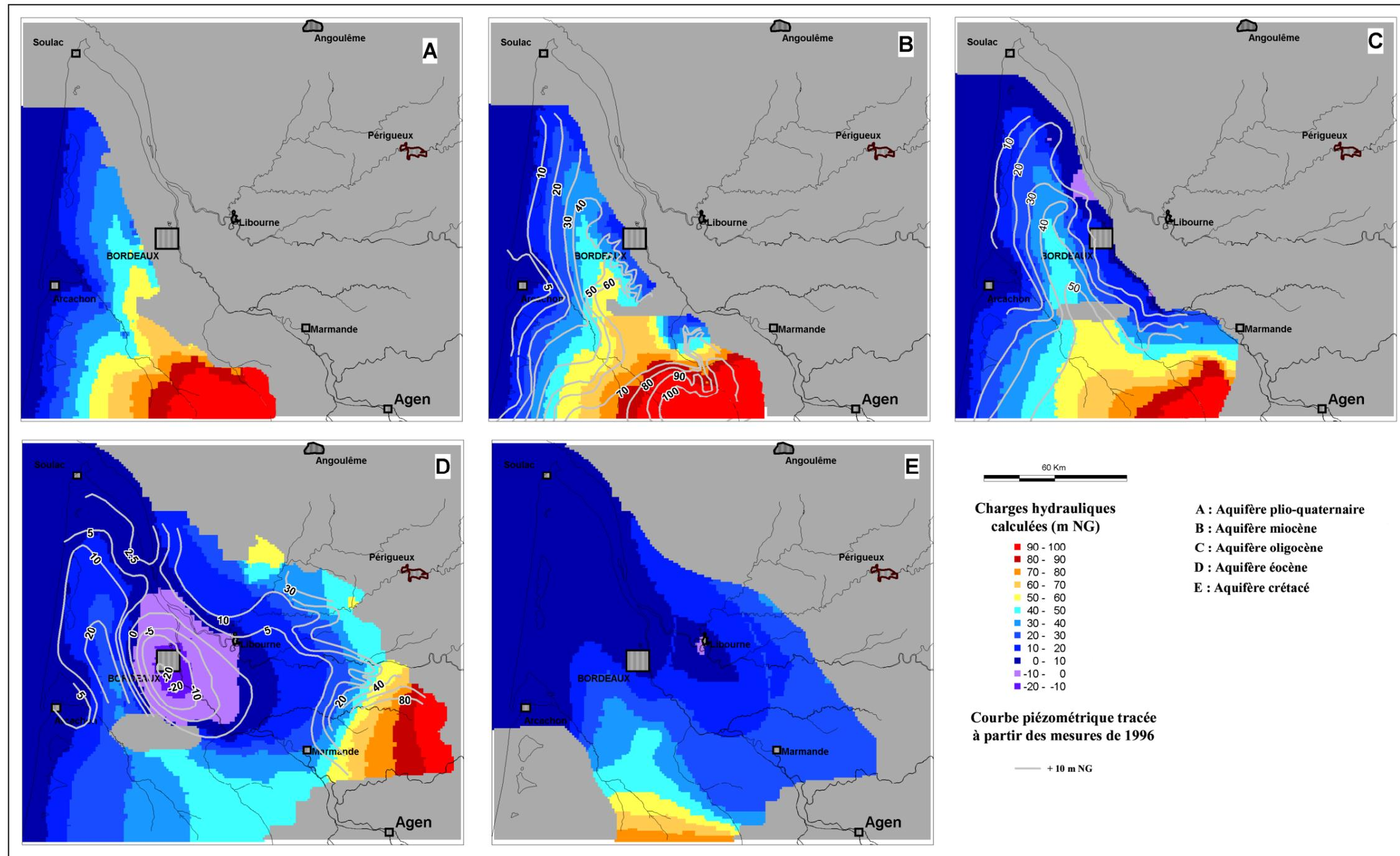
Figure I-45 : Cartes piézométriques calculées en régime permanent (données de 1981)
