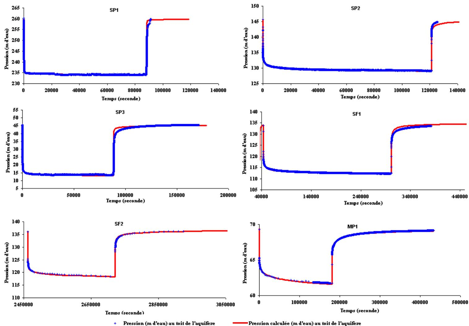
Figure II-11 : Evolution des pressions mesurées et simulées – Modèles variables
