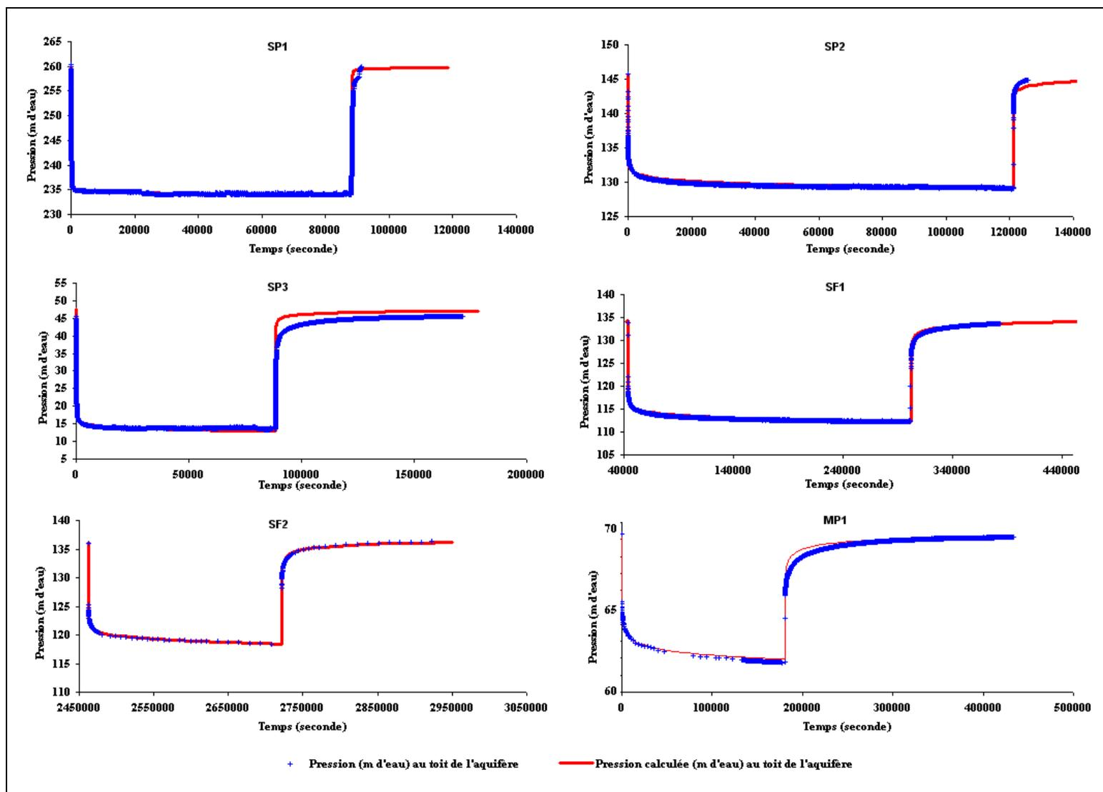
Figure II-9 : Evolution des pressions mesurées et simulées - Modèles homogènes d'extension infinie
