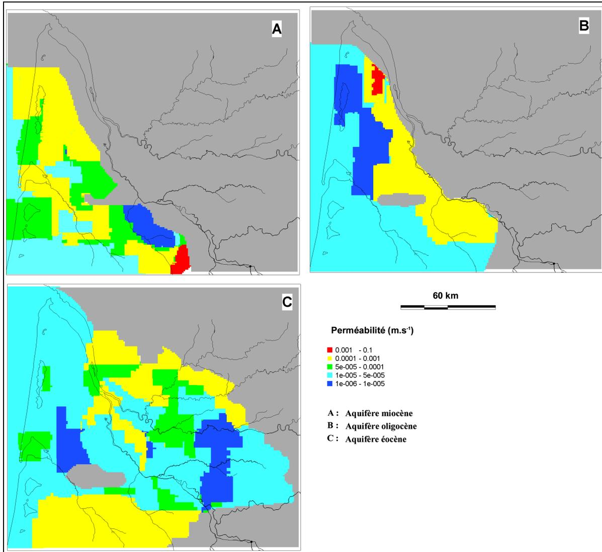
**Figure A1-1 : Champs de perméabilité pour les aquifères tertiaires obtenus après calage**
