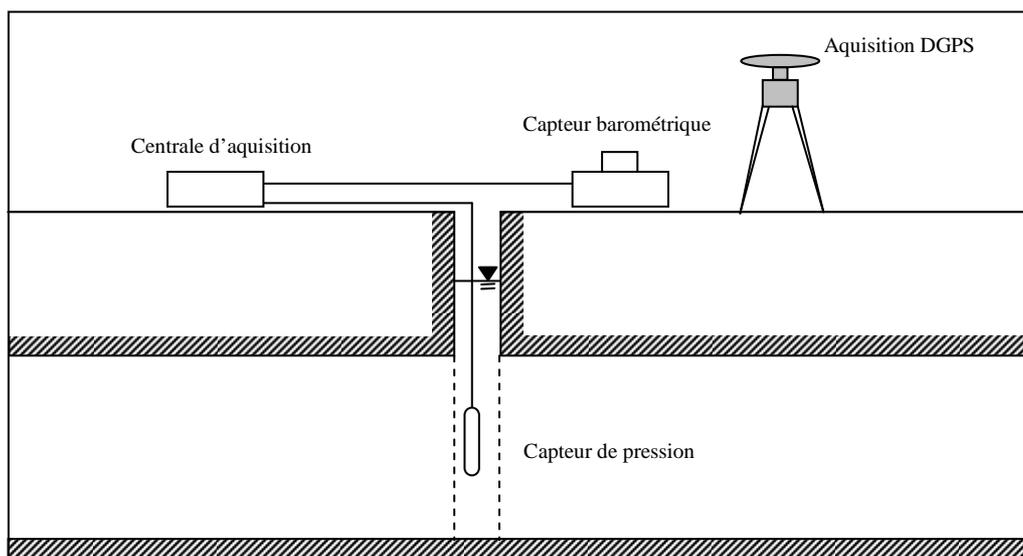
Figure II-18 : Dispositif d'acquisition – Forage MP1
