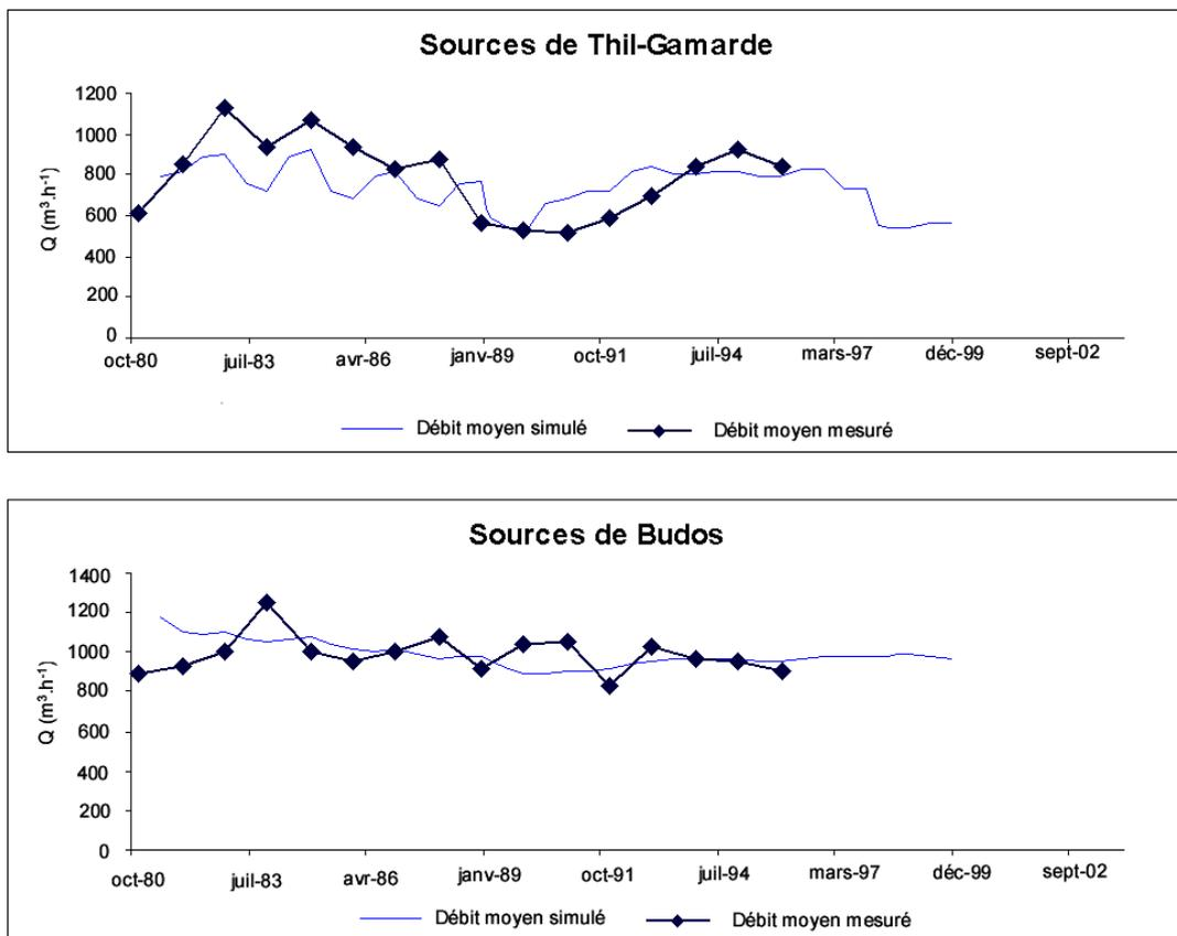
**Figure I-50 : Débits simulés aux sources oligocènes**
