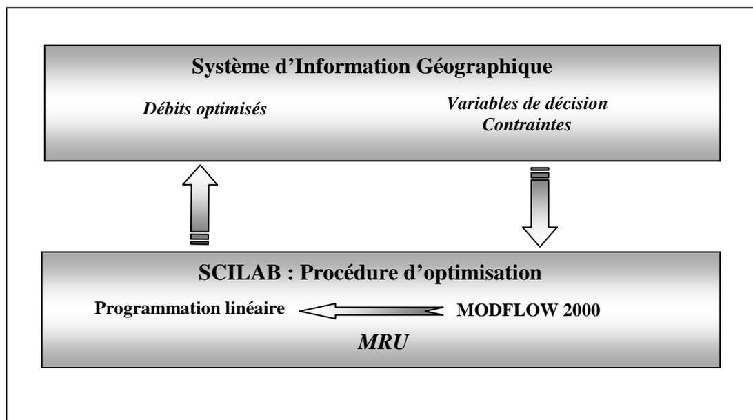
**Figure III-11 : Structure de la plate-forme d'optimisation développée**
