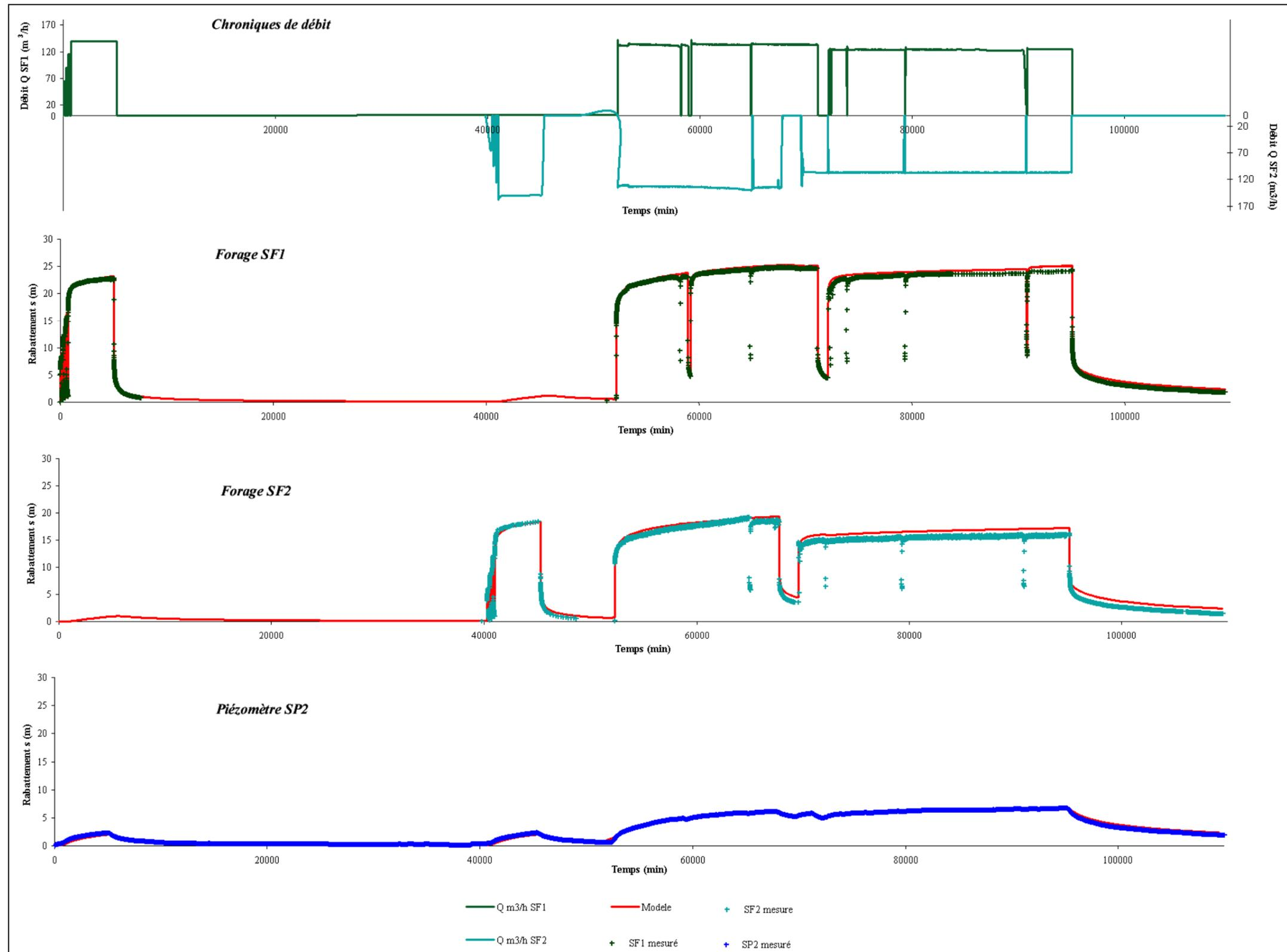
Figure III-3 : Rabattements mesurés et simulés pour l'essai d'interférence de longue durée
