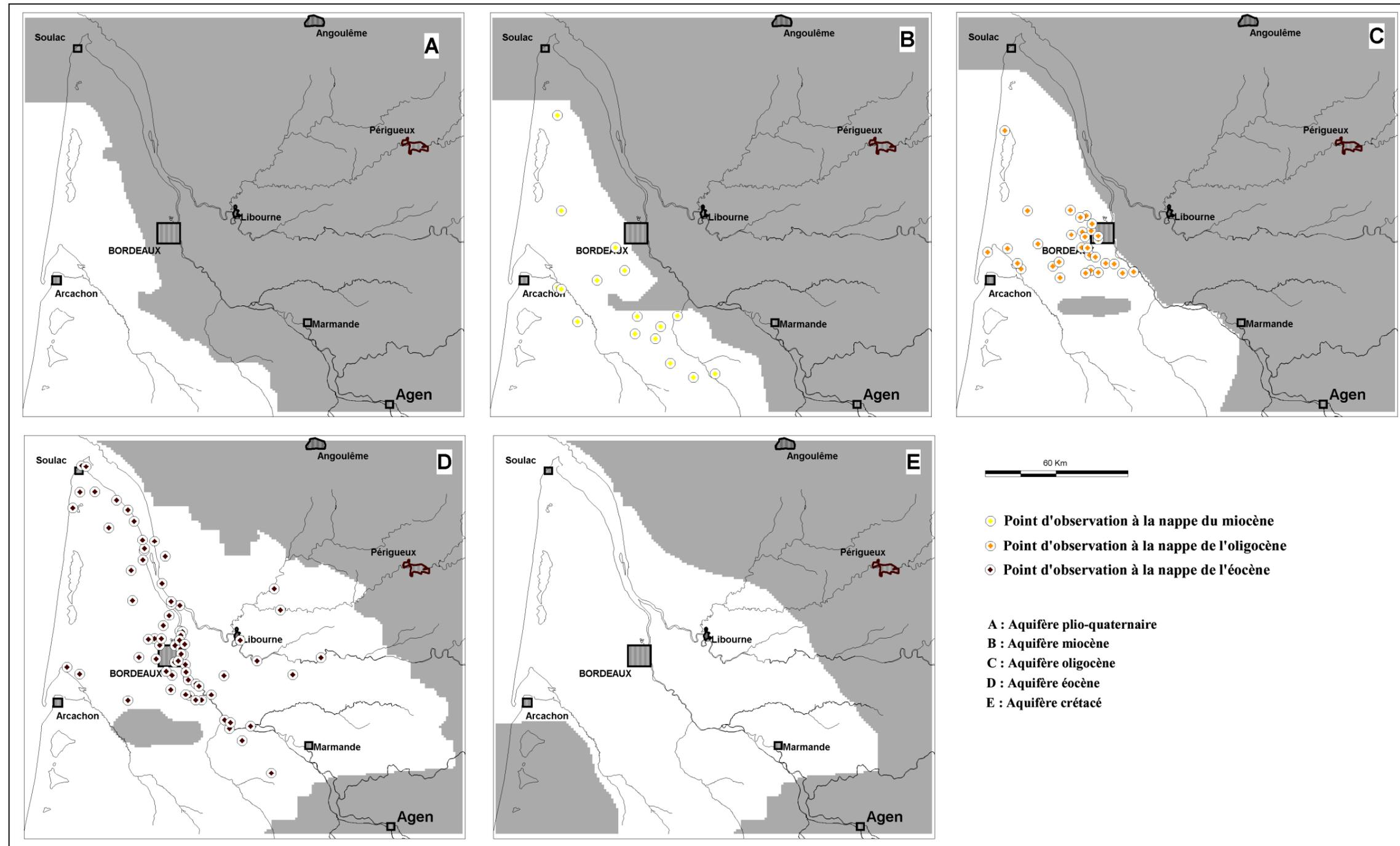
Figure I-44 : Localisation des piézomètres de contrôle
